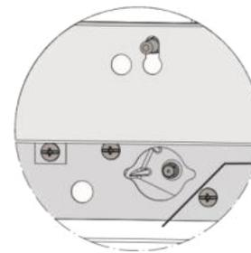
Entfernen Sie den Injektor und ersetzen Sie ihn mit einem passenden Injektor.
