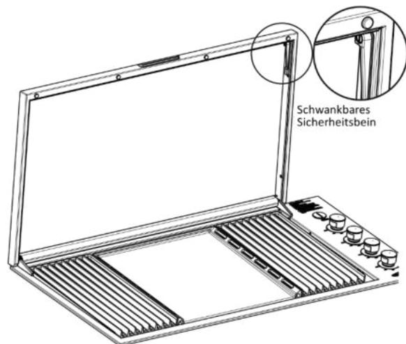
Beim Schließen des Deckels schwenkt das Sicherheitsbein vorne und stoppt auf der Kante, um ein Schließen des Deckels zu verhindern. Nachdem sichergestellt wurde, dass das Gas ausgeschaltet wurde, muss der Fuß zum vollständigen Schließen des Deckels nach innen gedrückt werden.
