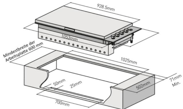
Alternativer Belüftungsausschnitt in der unteren Barriere (Frontseite zur besseren Übersicht nicht dargestellt)
