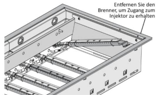
Entfernen Sie den Brenner, um Zugang zum Injektor zu erhalten
